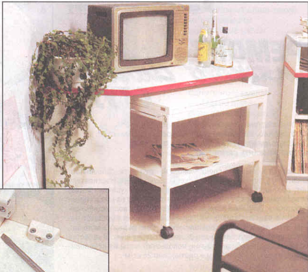
Угловой столик собирают на специальных мебельных стяжках. Можно использовать стяжки и другой конструкции.
