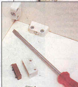
Угловой столик собирают на специальных мебельных стяжках. Можно использовать стяжки и другой конструкции.
