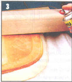
3 Клей на пеноматериал удобнее наносить из баллончика.
