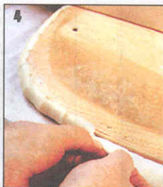
4 Края пеноматериала подворачивают побольше, чтобы не оторвался.
