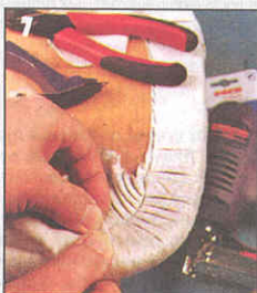
7 Каждую, даже самую узкую складочку равномерно закрепляют скобами.
