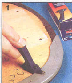
1 Специальный инструмент для вытаскивания скоб удобнее, чем отвертка или кусачки.
